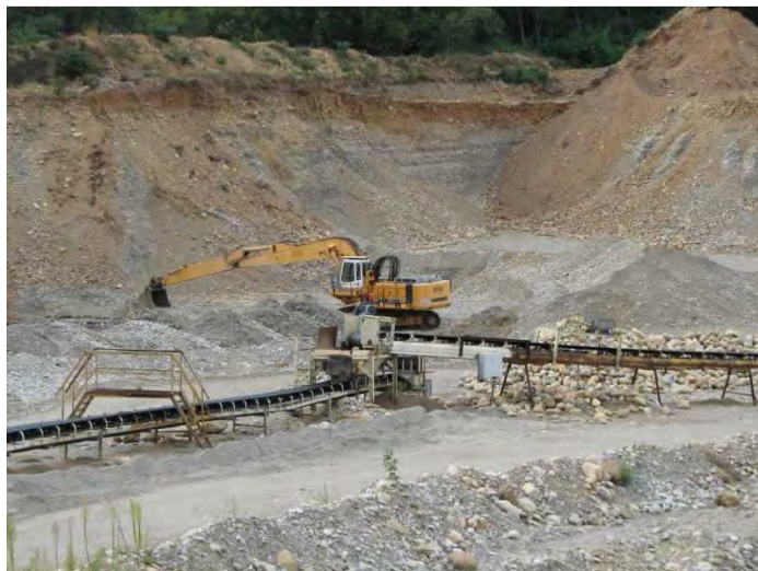
Carrière actuelle en exploitation à l'aide d'une pelle extractive et évacuation par convoyeurs à bandes
